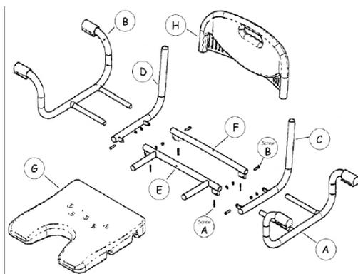
Шаг 1. Присоедините левую часть рамы (А) и правую часть рамы (В) к передней (Е) и задней (F) трубкам сиденья.
